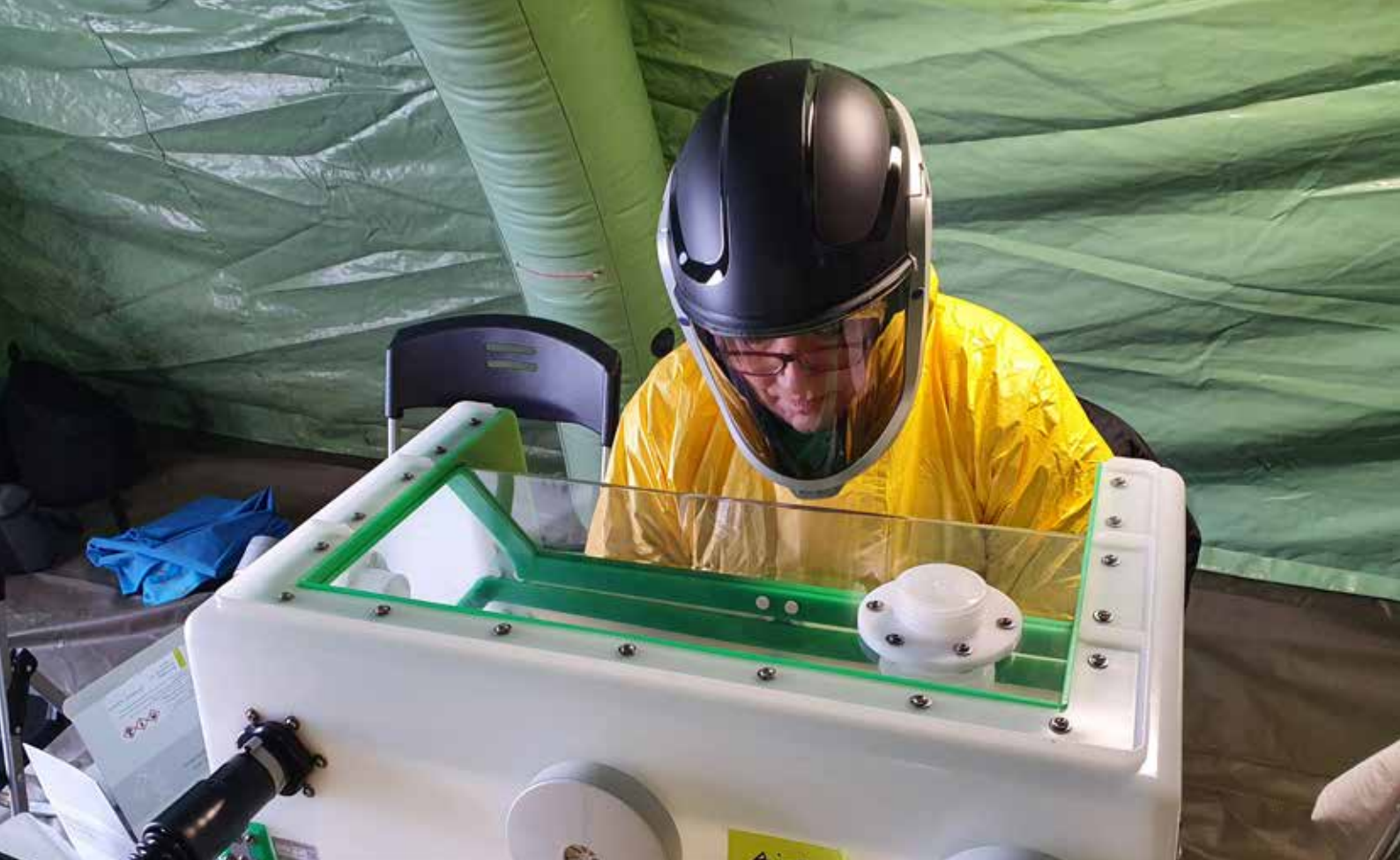
SVA testar en mobil laboratorieförmåga i Försvarsmaktens tält under totalförsvärsövningen "Vilde", Kiruna, 2023. En del av övningen involverade ett scenario där ett smittämne avsiktligt spreds. Proverna hanteras i en tillsluten handsbox. Full skyddsutrustning används. Foto: Öjar Melefors/SVA.
